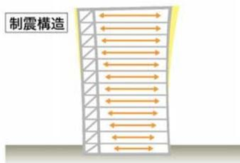
ダンパー等の設置により、揺れのエネルギーを吸収する構造。上階ほど揺れは激しくなるが、揺れの大きさは耐震建物よりも小さい。
