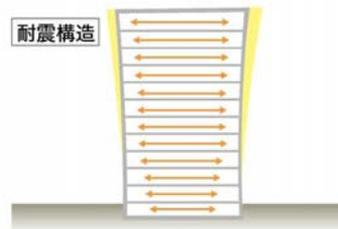
建物の柱や壁などの強度で建物の倒壊を防ぐ構造。上下階とも小刻みに激しく揺れ、上階ほど揺れは激しい。
